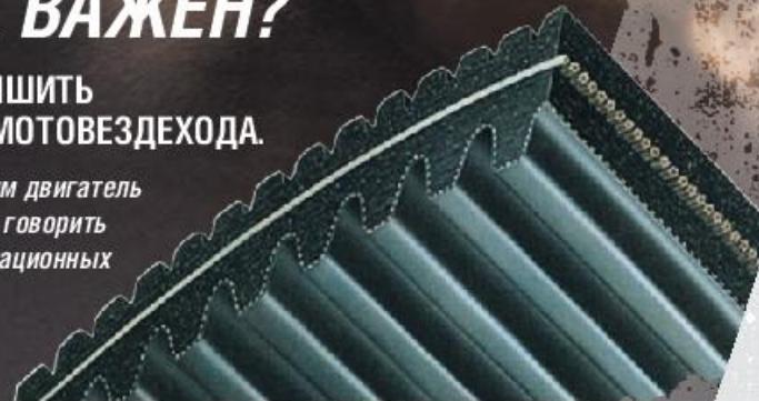
Компоненты вариатора откалиброваны для обеспечения оптимальных динамических характеристик. Использование неподходящего ремня может нарушить работу всей системы.
