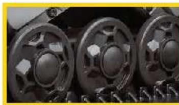
**Нанесение на усиленные литые катки слоя резины, а также оригинальное расположение самих катков позволило не только снизить воздействие силы трения и вибрации, но и обеспечить надежную работу системы.**
